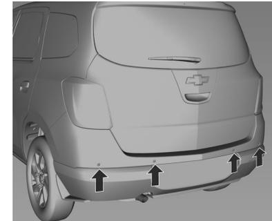
O sistema consiste em quatro sensores ultrassônicos de estacionamento localizados no para-choque traseiro.
