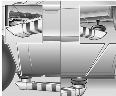
A figura mostra onde deverão ser instalados os suportes para um guincho ou macaco.
