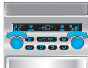
Controle eletrônico do condicionador de ar
